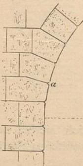
Aus dem Vergleiche dieser Gewölbstärke mit der im zweiten Beispiele geführten Rechnung ist wiederum deutlich der Vortheil zu erkennen, welcher sich für den Gewölbkörper mit den bis zur Bruchfuge in wagrechten Schichten ausgeführten Gewölbanfängern herausstellt.
