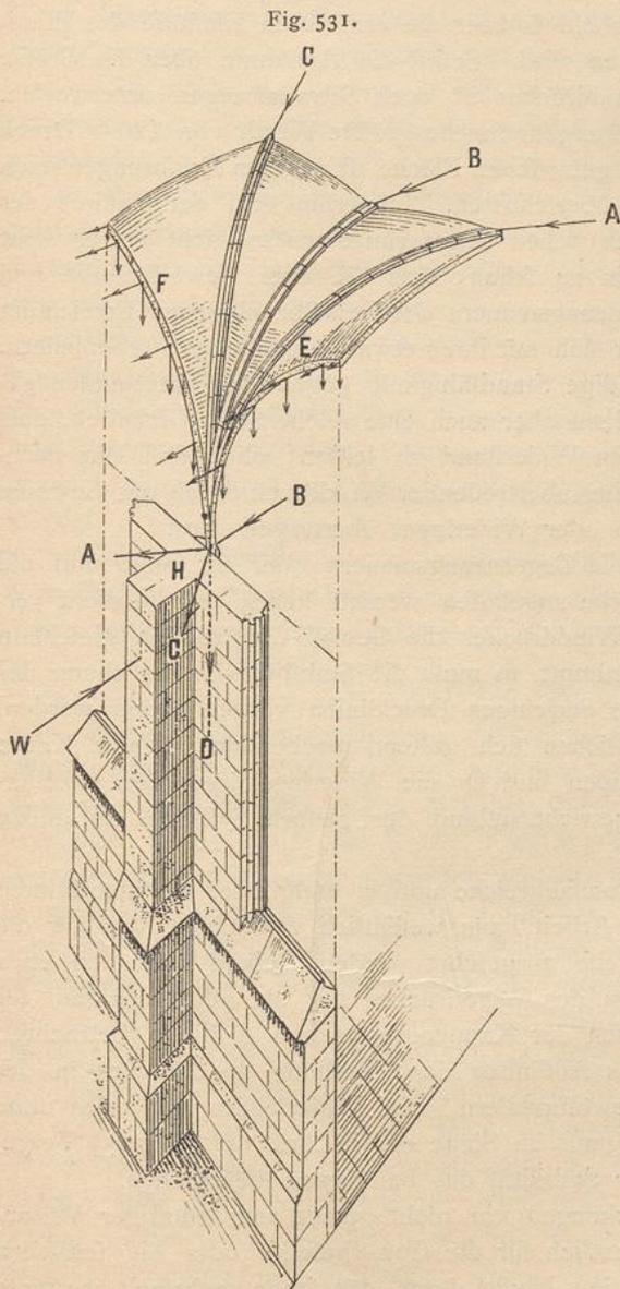
Eben so ist nach der Bestimmung des für den Rippenbogen entstehenden Horizontal Schubes, bezw. Normaldruckes, unter Anwendung der Gleichungen 142 u. 148 (S. 185 u. 186), bezw. der Gleichungen 145 u. 150 (S. 186 u. 187) die Stärke der Rippen bei Anwendung von Quadermaterial oder von Backsteinen zu berechnen.
