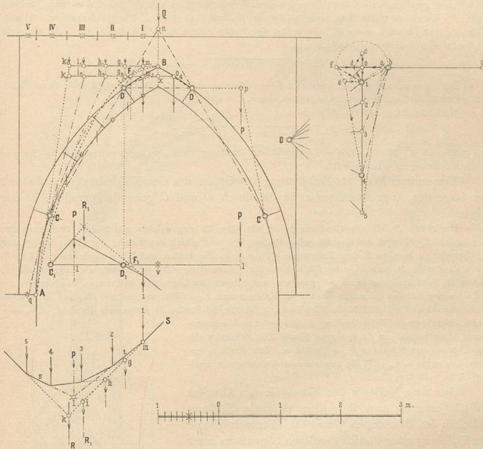
eine Mittellinie des Druckes für die Punkte  $B$  und den vorderen Punkt  $A$  der Widerlagsfuge gezeichnet. Dieselbe verläßt jedoch die Stirnfläche des Gewölbes oberhalb der Rückenlinie und unterhalb der inneren Wöblinie; sie kennzeichnet in den Punkten  $D$  und  $C$  zwei Bruchfugen, und folglich ist der für diese vorläufige Mittellinie des Druckes ermittelte Horizontalschub  $ao$  noch nicht fähig, den Gleichgewichtszustand im Wölbssystem herzustellen.
