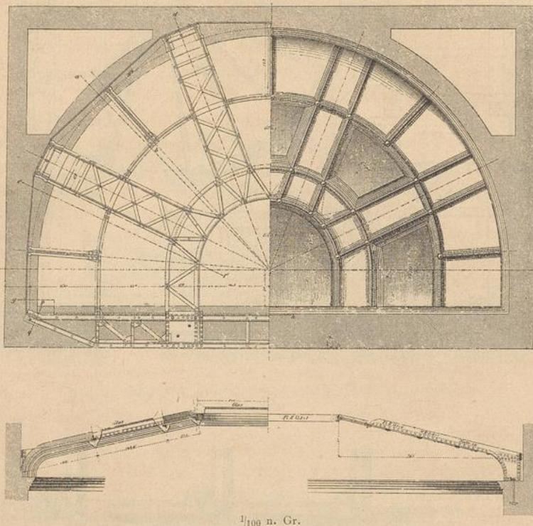
Die Eisen-Construction bildet hier die Hälfte einer Kuppel, in der die auf Druck beanspruchten Constructionstheile als Gitterträger ausgebildet sind. Als eigentliches Tragssystem sind dabei der gitterförmige Druckring, die 4 radial angeordneten Gittersparren, der Zugring, welcher die Auflager der letzteren verbindet, und der wagrechte Fachwerkträger, welcher die fehlende Kuppelhälfte ersetzt, zu betrachten<sup>242)</sup>.
