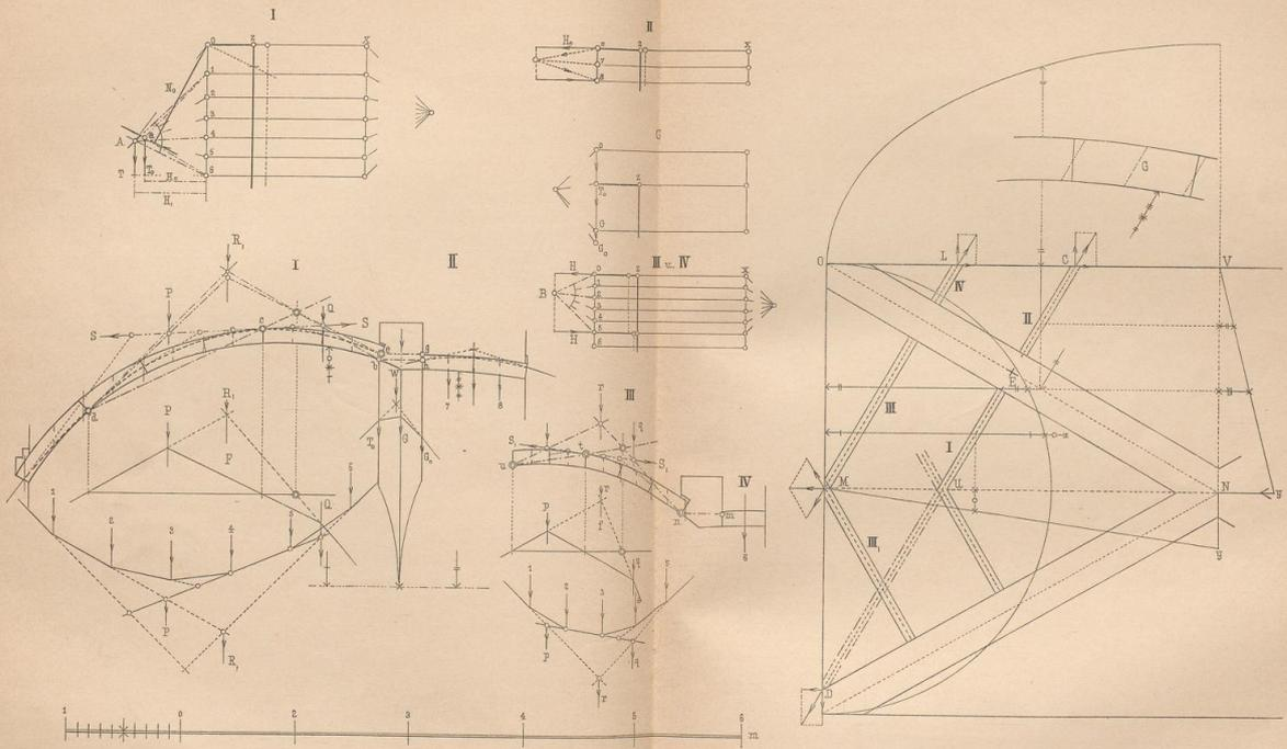
Stabilitäts-Unterfuchung eines cylindrischen Kreuzgewölbes mit Schwalbenschwanz-Verband.
