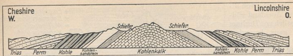
476. Geologischer Schnitt durch das nördliche Penninengewölbe. (Nach der amtlichen geologischen Karte.)
