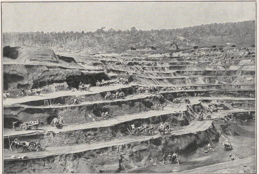
1081. Südlicher oder waldreicher Ural. Gewinnung der Magneteisenerze in einzelnen Terrassen und im Tagebau. Die Eisenerze zeichnen sich durch besondere Reinheit (55–60 v.H.) aus. Die Abfuhr geschieht durch leichte zweirädrige Karren.
