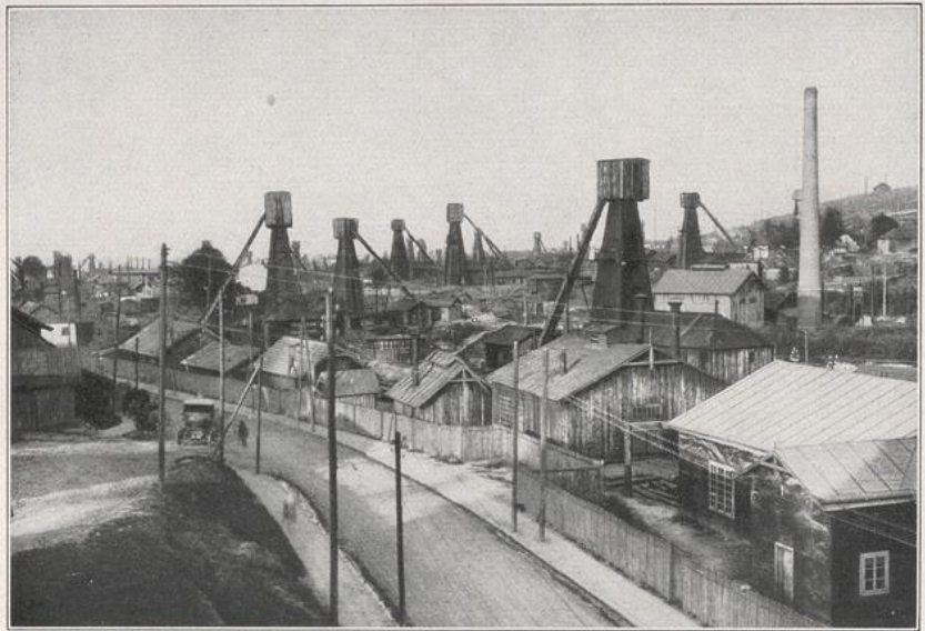
377. Bohrtürme bei Borislaw. Nur aus wenigen „eruptiven“ Schächten schleudern die Gase das Öl selbsttätig heraus. Gewöhnlich wird es bei Flachbohrung gepumpt, sonst gekolbt, wie im Borislauer Revier. Ein Drahtseil läßt den Kolben bis zum Boden des Bohrlochs herab und zieht mit ihm dann die über ihm befindliche Ölsäule empor.
