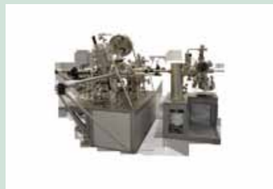
UHV-Analytiksystem PIA (Paderborn Integrated Analysis-System for Interface Science), mit den Methoden XPS, AES, UPS, ISS, SEM, AFM, STM, LEED, Ionenstrahlbehandlung
