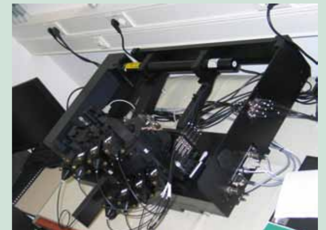
Die Neuanschaffung einer Vielwinkellichtstreuungsanlage ermöglicht es kombinierte statische und dynamische Lichtstreuung zeitauflösend und parallel unter 8 Winkeln zu messen und damit online Wachstumsprozesse von Nanoteilchen zu untersuchen.
