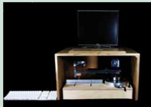
Versuchsaufbau zur Leistungsmessung motorisch-kognitiver Doppeltätigkeit. Eingesetzt in unterschiedlichen Untersuchungen zu motorischen Automatisierungsprozessen
