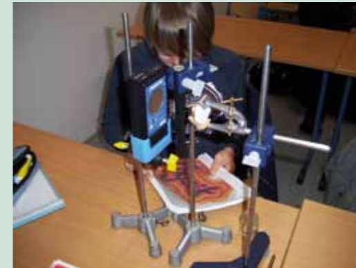
Interesse fördernder Unterricht: Füllstandsmessung mit Isotopenmesstechnik
