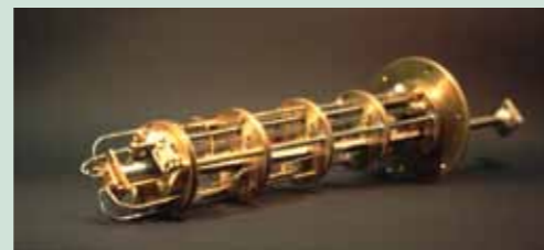
Eigenentwicklung eines Höchstfrequenzkryosystems für elektrisch detektierte magnetische Resonanz
