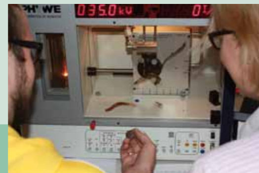
Analyse der Legierungselemente von Schmuck und Tafelsilber mit energiedispersiver Röntgenspektroskopie im Schülerlabor
