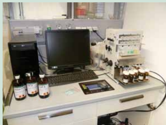
Am DNA/RNA-Synthesizer werden mittels automatisierter Methodik kurze Nucleinsäuren (Oligonucleotide) mit modifizierten Strukturen hergestellt
