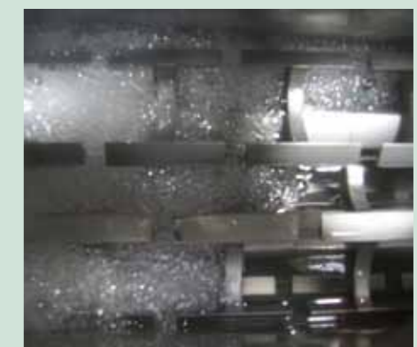
Entgasung hochviskoser Fluide im Knetern am Beispiel n-Heptan/Silikonöl
