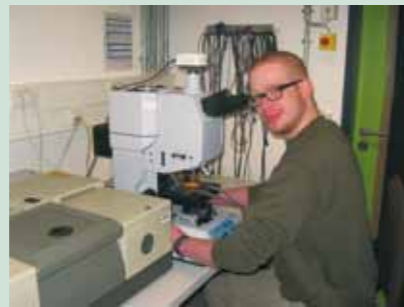
Herr Bernhard Atorf am FTIR-Mikroskop, mit dem neuartige, schaltbare Metamaterialien charakterisiert werden, die in Zusammenarbeit mit der Arbeitsgruppe von Prof. Zentgraf, Experimentalphysik hergestellt wurden.
