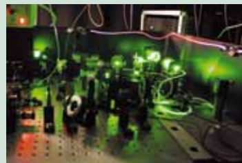
Erzeugung angekündigter Einzelphotonen
