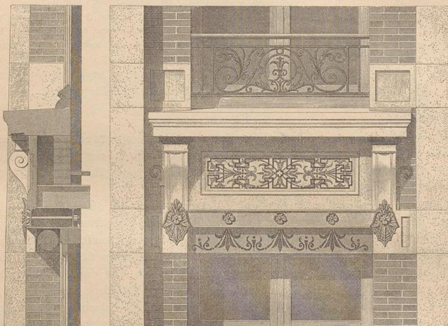
Ein Beispiel hierfür bei gewöhnlicher Fensterweite bietet Fig. 927<sup>880</sup>). Das Auflager der Träger ist durch aufgelegte Gufsverzierungen verdeckt. Das Beispiel zeigt zugleich, wie in solchen Fällen äussere Rollläden angebracht werden können.
