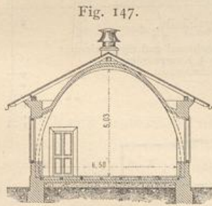
Pavillonkaserne. System Gruber-Völckner. 1/1250 w. Gr.
