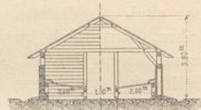
Blockwand- Flechtwerk- Baracke.
