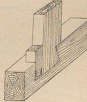
Fig. 419 bis 421 zeigen lösbare Verbindungen von Ständern und Rahmhölzern oder Schwellen mit Hilfe von Schlitz-, bezw. Schwalbenschwanzzapfen und Holzkeilen.
