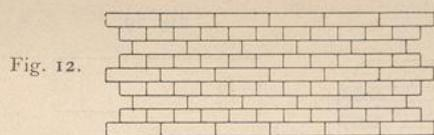
b) die Läufer in einer Schicht um die andere um  $\frac{1}{2}$  Steinlänge verschoben (Fig. 12) — Kreuzverband;
