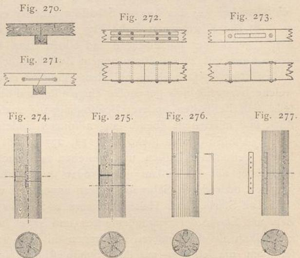
Schienen, welche über den Stofs genagelt und, zur Vermeidung von Verbiegungen durch Druck und Stofs, mit nach der Längsachse ovalen Nagellöchern versehen werden (Fig. 277), angewendet. Diese Verbindungen eignen sich besonders zum Aufpfropfen von Rammpfählen für Pfahlrostgründungen, weil sie die Pfähle beim Einrammen am meisten gegen das Spalten oder Splittern schützen.
