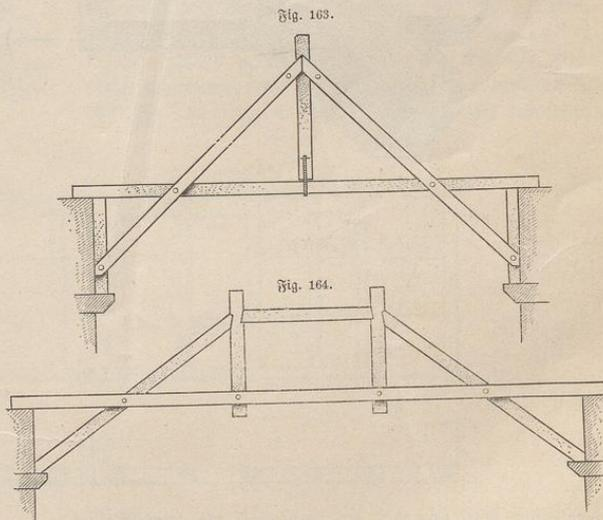
die Streben eines Sprengwerkes bilden und Stützpunkte für den Tramen abgeben, Fig. 163.
