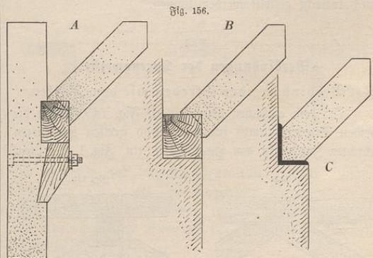
wo sich Wasser sammelt, leicht der Fäulnis anheimfällt, und es ist besser, in der Höhe des Strebenansatzes einen Absatz anzuordnen und die Strebe auf die nunmehr freiliegende Schwelle aufzuklaulen, Fig. 156 B.
