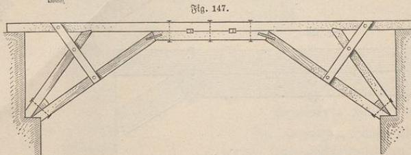
und verbolzt, so erscheint der Teil a b als verstärkter Balken und kann demgemäß länger genommen werden, wodurch ein vorteilhafter Winkel für die Streben erreicht und der Horizontalschub auf die Widerlager geringer wird.
