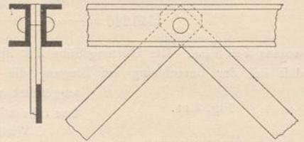
kann angenommen werden, daß sich die Querkraft gleichmäßig auf die vom lotrechten Schnitte getroffenen Gitterstäbe verteilt, d. h. bei  $n$ -fachem Gitterwerke muß die lotrechte Seitenkraft der Spannkraft eines Stabes dem  $n$ -ten Teile der Querkraft gleich sein. Hiernach lassen sich die Stabspannungen leicht berechnen, welche der Berechnung des Anschlusses an die Gurtungen, sowie, wenn sie Druck ergeben, der Berechnung der Stäbe auf Zerknicken zu Grunde zu legen sind.
