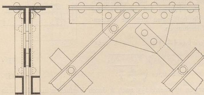
und daher werden unter Umständen Knotenbleche erforderlich (Fig. 511, S. 190 u. Fig. 624). Die einfachsten Formen lassen sich aus Fig. 618 bis 621 dadurch ableiten, daß man die Flacheisen durch L- oder C-Eisen ersetzt, dabei aber die etwa vorhandenen lotrechten Steifen wegläßt. Anderweitige Anordnungen zeigen Fig. 622 bis 624. Die gedrückten, von einem gezogenen gekreuzten Gitterstäbe können als im Kreuzungspunkte gegen Zerknicken ausgesteift angesehen werden.
