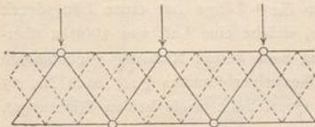
Die Gitterstäbe sollen mindestens etwa 30 Grad gegen die Wagrechte geneigt sein. Ist also die Lastteilung mit Rückficht auf Zerknicken als Knotenteilung zulässig, und bleiben die Stäbe dabei steiler als 30 Grad, so wird nur ein Dreiecksnetz von Gitterstäben eingefügt (Fig. 608); kommen dabei aber die Stäbe flacher zu liegen, als 30 Grad, so
