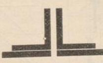
lotrechten Mittelschlitz angeordnet werden. Ist die Gurtung in Fig. 614 mit Schlitz versehen und kann Nässe den Träger erreichen, so muß die untere Gurtung die Gestalt von Fig. 617 erhalten, damit sich das Wasser im Schlitze nicht anfammelt.
