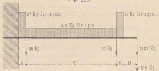
Werden hier je  $n$  Schienen von 13 cm Höhe ausgekragt, so ist das  $s$ -fache Widerstandsmoment bei einer Beanspruchung von  $s = 700$  kg für 1 qcm nach Gleichung 245:  $n \cdot 0,07 \cdot 13^3 \cdot 700 = 107653 n$ . Demnach folgt aus  $107653 n = M = 177400$  die Zahl der Schienen  $n = 2$ .
