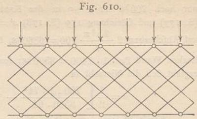
Der Querschnitt  $f$  der Gurtung ergibt sich aus dem Angriffsmoment an der untersuchten Stelle, wenn  $h$  die Höhe zwischen den Gurtungsschwerpunkten und  $s'$  die zulässige Spannung bezeichnet, aus den Gleichungen 194 u. 195 (S. 343<sup>144</sup>) des eben genannten Halbbandes zu
