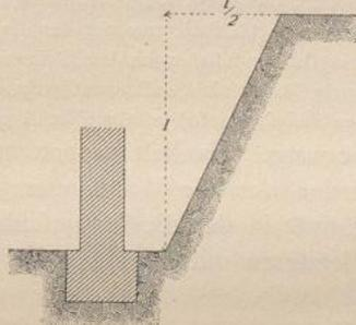
häufig bei den Fundamentgräben der Fall, die innerhalb der erschlossenen Baugrube noch besonders ausgehoben werden und meist eine nur geringe Tiefe erhalten (Fig. 676).
