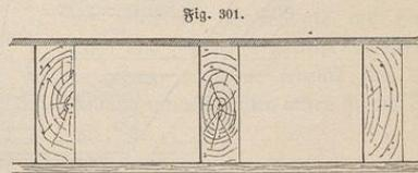
meistens die Zwischendecke gänzlich, und die Balken sind dann nur zur Bildung des Bodens mit einem starken Dielenbelage, und eventuell auf der Unterseite mit einer Bretterverschalung versehen, Fig. 301. Wenn die letztere fehlt, ist eine stellenweise Absteifung der Balken gegen Drehung empfehlenswert.
