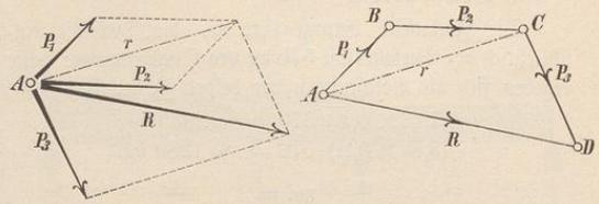
mit dem Anfangspunkte zusammen, dann ist der Kräfte-zug geschlossen, die Resultierende ist Null und die sämtlichen Kräfte sind miteinander im Gleichgewicht. Bei einem solchen Kräfte-plan oder Kräfte-polygon haben die sämtlichen Kräfte dieselbe Pfeilrichtung. Fig. 341.
