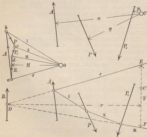
Diese Vertikalkräfte lassen sich ebenfalls graphisch darstellen; so ist z. B., Fig. 349, die Vertikalkraft im Punkte A:
