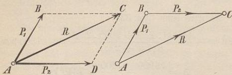
Satz 2. Soll die mit den Kräften  $P_1$  und  $P_2$  das Gleichgewicht haltende Kraft ermittelt werden, so ist R gleich groß aber entgegengesetzt, also im Kräfte-dreieck mit umgekehrter Pfeilrichtung, von C nach A anzubringen, Fig. 339, so daß sich die Richtungspfeile der Kräfte nicht mehr begegnen, sondern in demselben Sinne fort-schreiten.
