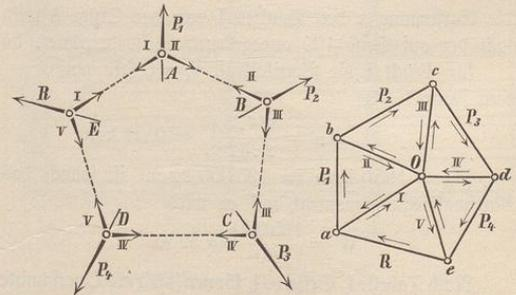
an, deren Größe in dem Kräfte-dreieck Oab bestimmt wird, verlängere II bis zum Schnitt mit  $P_2$ , bestimme im Kräfte-dreieck Obo eine Gleichgewicht haltende Seitenkraft III durch Ziehen der Schlusslinie Oo, verlängere III bis zum Schnitt mit  $P_3$ , bestimme wie vor die das Gleichgewicht haltende Seitenkraft IV durch Ziehen der Schlusslinie Od, verlängere IV bis zum Schnitt mit  $P_4$ , ermittle wieder
