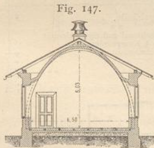
Pavillonkaserne. System Gruber-Völckner. 1/1250 w. Gr.
