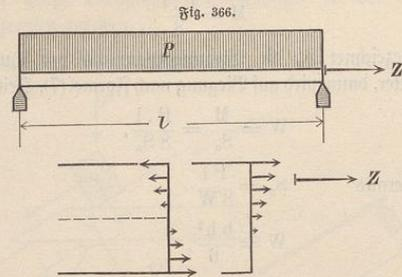
Diese beiden Spannungen heben sich aber mehr oder weniger auf, so daß die in den unteren Fasern herrschenden Spannungen die größeren sind. Es genügt deshalb, die so belasteten Bundbalken unter Vernachlässigung der Zugspannung  $Z$  einfach nach der gleichmäßig verteilten Decklast auf Biegung zu berechnen, d. h. nach Formel (23 a), wonach wird  $bh^2 = 0,0125 Pl$ .
