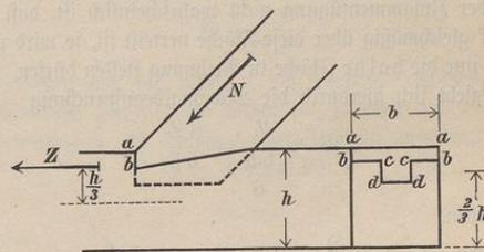
die Lastübertragung hauptsächlich durch den Kopf  $ab$  der Verzapfung erfolgt, so wirkt somit auch diese Normalspannung nicht in der Stabachse, sondern oberhalb derselben, und zwar wird man nach den tatsächlichen Verhältnissen annehmen können, daß  $Z$  in der Entfernung  $\frac{h}{3}$  von der Stabachse angreife.
