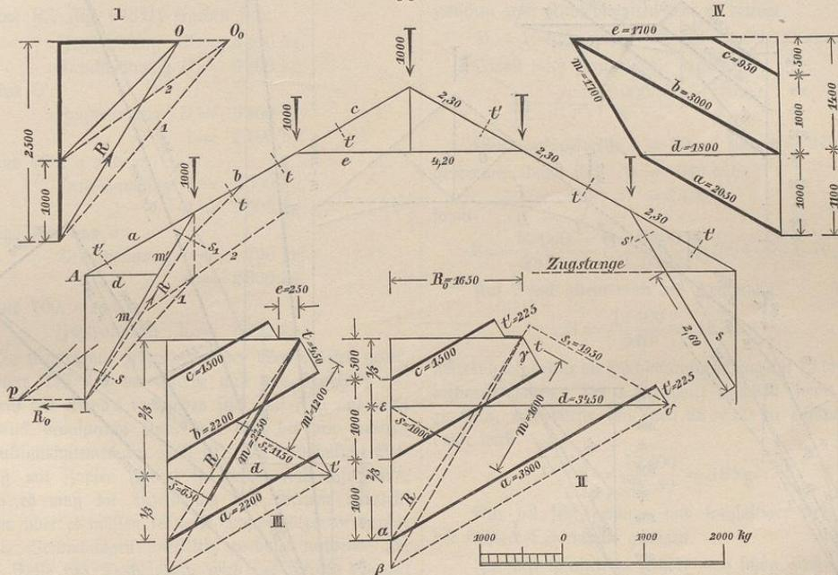
biegt sich in einer Richtung, der untere Teil entgegengesetzt und diese zwei Biegungen sollen sich ausgleichen. Deshalb muß ein Resultanten-Polygon ungefähr durch die Mitte des freien Stückes der Strebe gehen.
