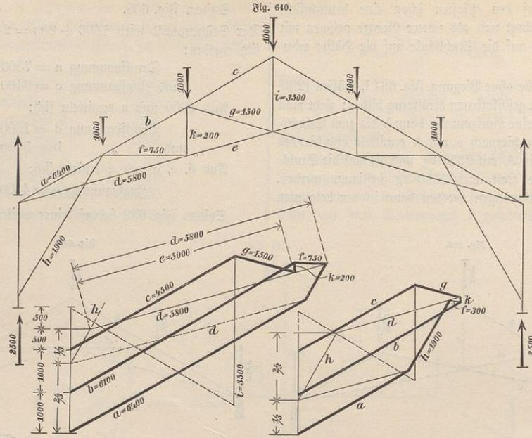
hierauf die Abmessungen entsprechend verstärken, und, wo es zulässig ist, sollten die Streben nicht an derselben Stelle anfallen. Der Kräfteplan wird somit aufgestellt unter der Annahme, daß der Pfosten keine Biegung erfahre. Die
