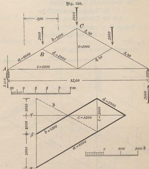
Die sämtlichen an einem Knotenpunkte wirkenden Kräfte und Lasten müssen im Gleichgewicht sein, und müssen mithin, nach einem beliebigen Maßstab aufgetragen, ein geschlossenes Kräftepolygon mit einerlei Pfeilrichtung ergeben, s. Kap. VI, § 10. Es dürfen aber an jedem Knotenpunkte immer nur zwei Unbekannte vorhanden sein, da nach mehr als zwei Richtungen nicht zerlegt werden kann.
