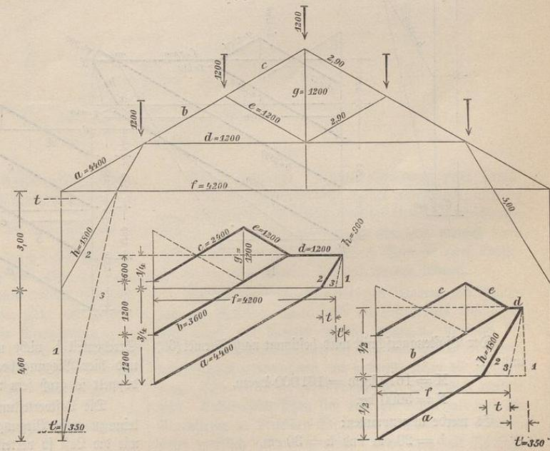
erhalten werden.  $t$  vermehrt die ursprünglich erhaltene Spannung  $f$  in der in den Kräfteplänen angegebenen Weise, so daß die der Querschnittsberechnung zu Grunde zu legenden Werte sind:
