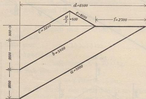
Kräftepläne zu verzeichnen und die Querschnitte nach den größten der ermittelten Spannungen zu berechnen. Als Grenzen der Belastung der Stuhlhäulen wird man  $\frac{1}{3}$  und  $\frac{2}{3}$  der Auflagerreaktion annehmen können.
