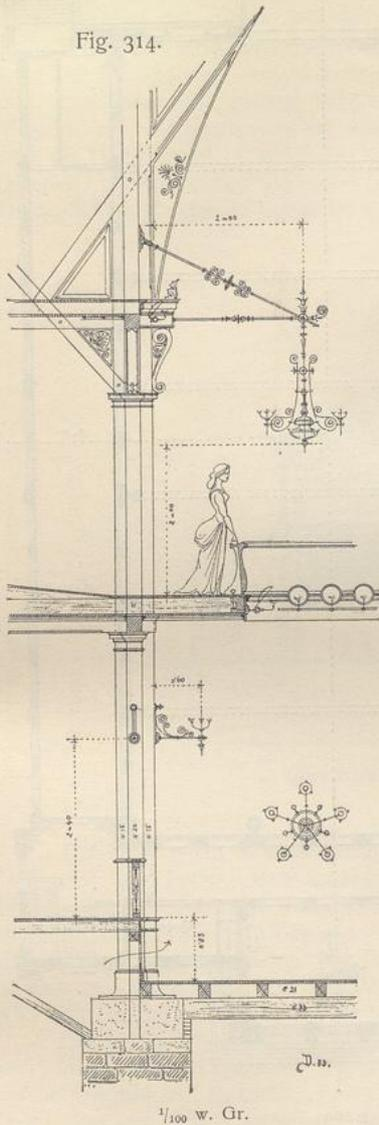
Die in den Abmessungen bescheidenere, von *F. Eisenlohr* erbaute Kunst- und Festhalle zu Freiburg i. Br. ist nach ähnlichen einfachen Grundrätzen erbaut, mit massivem Unter- und Umfassungsbau und hölzernem Innen- und Dachbau. Eine offene gewölbte Vorhalle führt zu ebener Erde in das dreischiffige Innere mit feinen Holzgalerien und ursprünglich hoch gespanntem, sichtbar gelassenem Dachstuhl.
