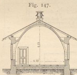
Pavillonkaserne. System Gruber-Völckner. 1/1250 w. Gr.
