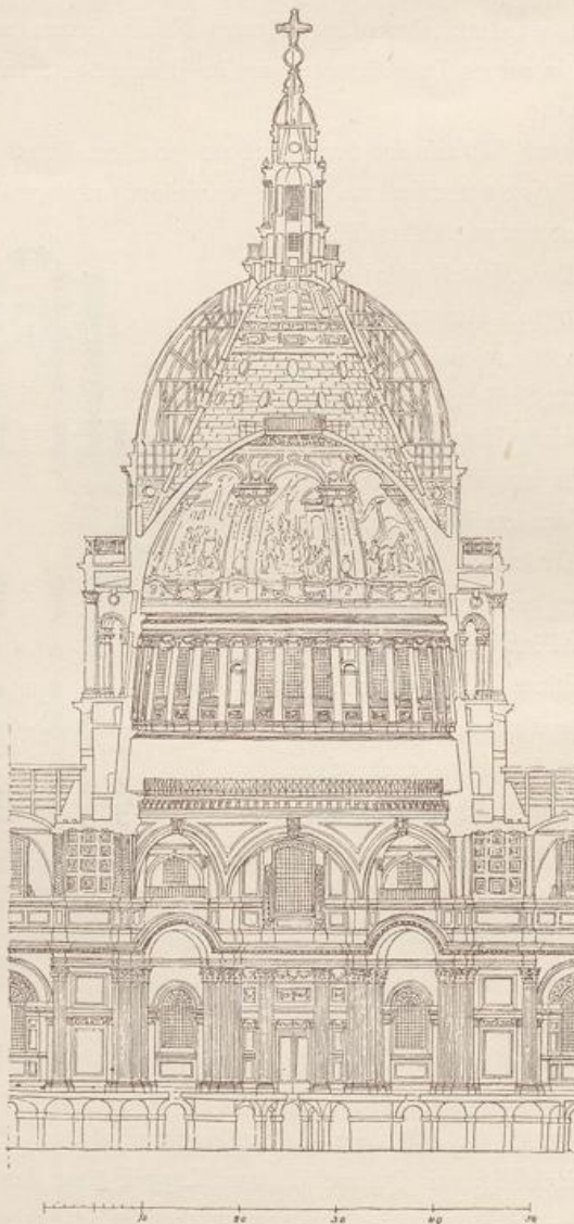
Fig. 236. Längenschnitt von St. Paul in London (n. Gailhabaud).
