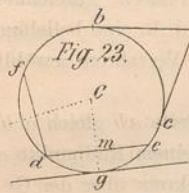
Eine Gerade wird zur Tangente, wenn die vom Mittelpunkt auf sie gefällte Senkrechte gleich dem Radius ist; die Tangente hat mit der Peripherie nur einen Punkt gemein und steht auf dem an den Berührungs punkten gezogenen Radius senkrecht.\*.) Von einem Punkte  $a$  ausserhalb des Kreises können nur zwei Tangenten an denselben gelegt werden; die Entfernung der Berührungs punkte  $b, c$  (Fig. 23) von dem gegebenen Punkte sind gleich.
