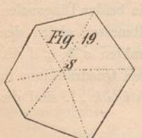
Um sich davon zu überzeugen, wähle man innerhalb des Sechseckes einen beliebigen Punkt  $S$  (Fig. 19), ziehe von den Ecken Gerade nach  $S$ , wodurch das Polygon in sechs Dreiecke zerlegt wird.
