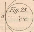
Summe ihrer Halbmesser; die Berührung heisst in diesem Falle eine äussere (siehe Fig. 24). Zwei Kreise berühren sich, wenn der Abstand der beiden Mittelpunkte gleich ist dem Unterschiede (Differenz) der beiden Halbmesser (siehe Fig. 25); die Berührung heisst in
