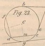
Eine Gerade wird zur Tangente, wenn die vom Mittelpunkt auf sie gefällte Senkrechte gleich dem Radius ist; die Tangente hat mit der Peripherie nur einen Punkt gemein und steht auf dem an den Berührungs punkten  $b, c$  (Fig. 23) von dem gegebenen Punkte sind gleich.
