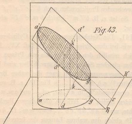
die kleine Achse  $d'' o'' k''$  u. s. w.  $d'' r'$  bildet dabei zugleich auch die Tangente an den gleichen Punkt  $d''$  der Ellipse.
