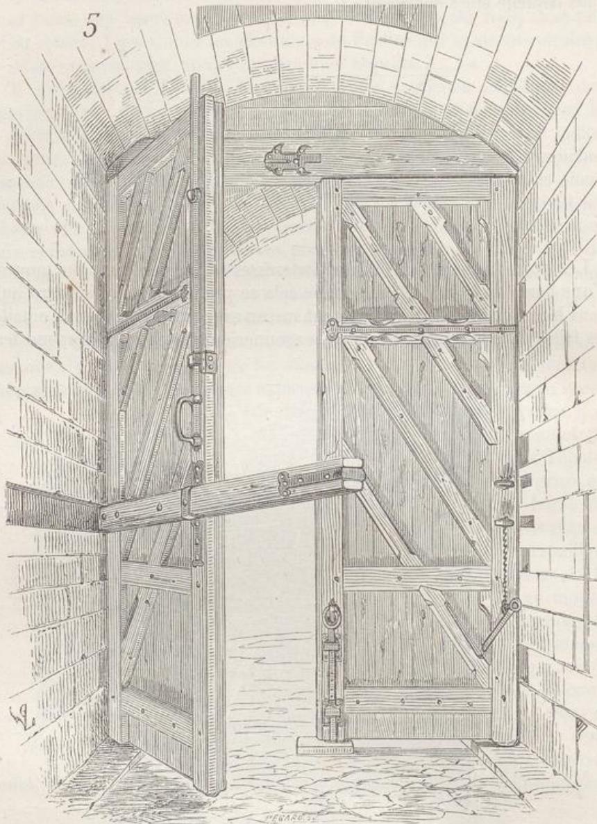
poser d'autres barres mobiles engagées à leurs extrémités dans des trous carrés pratiqués dans les ébrasements.
