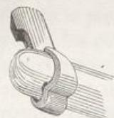
Dans la charpente, la serrurerie et la grosse menuiserie, les clavettes qui passent à travers l'extrémité des boulons sont souvent doubles à la queue ; les deux pointes étant recourbées, la clavette ne pouvait plus sortir (voy. fig. 2).
