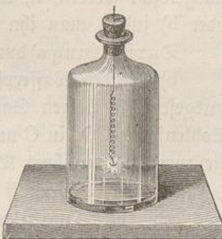
Fig. 7. Verbrennen einer Uhrfeder in reinem O.
