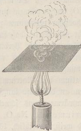
Fig. 8. Niederdrücken einer Flamme mittels eines Drahtneßes.
