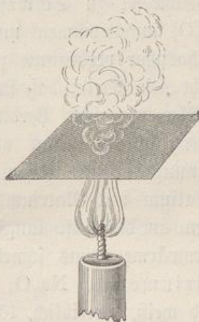
Fig. 8. Niederdrücken einer Flamme mittels eines Drahtneßes.
