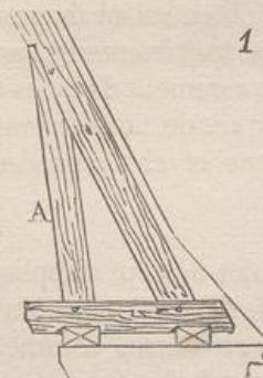
trier d'une ferme ou un chevron et s'assemble dans l'entrait ou le blochet. A (1) est une jambette (voy. **CHARPENTE**).
