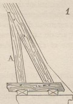
trier d'une ferme ou un chevron et s'assemble dans l'entrant ou le blocet. A (1) est une jambette (voy. CHARPENTE).
