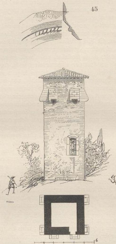
on montait à celui des mâchicoulis par une échelle de meunier<sup>1</sup>. L'ornement en torsade qui décore le linteau de la porte indique une époque assez ancienne. Au Cannet, cette tour est connue sous le nom de la *Maison du brigand*. Le dernier étage est voûté en moellon sous le comble. On voit encore, en Corse, un certain nombre d'habitations de ce genre.
