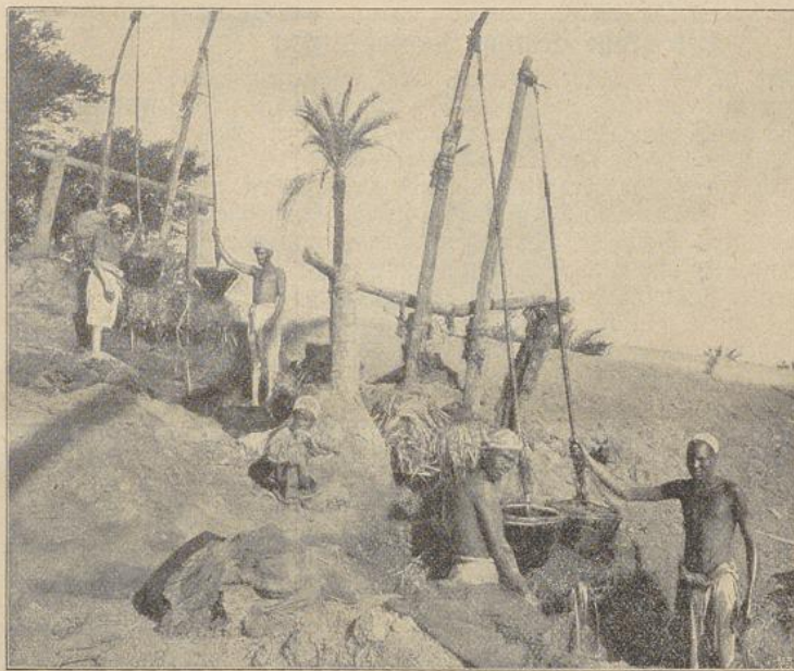
Bewässerung der Felder vermittelt des Schadufs.
