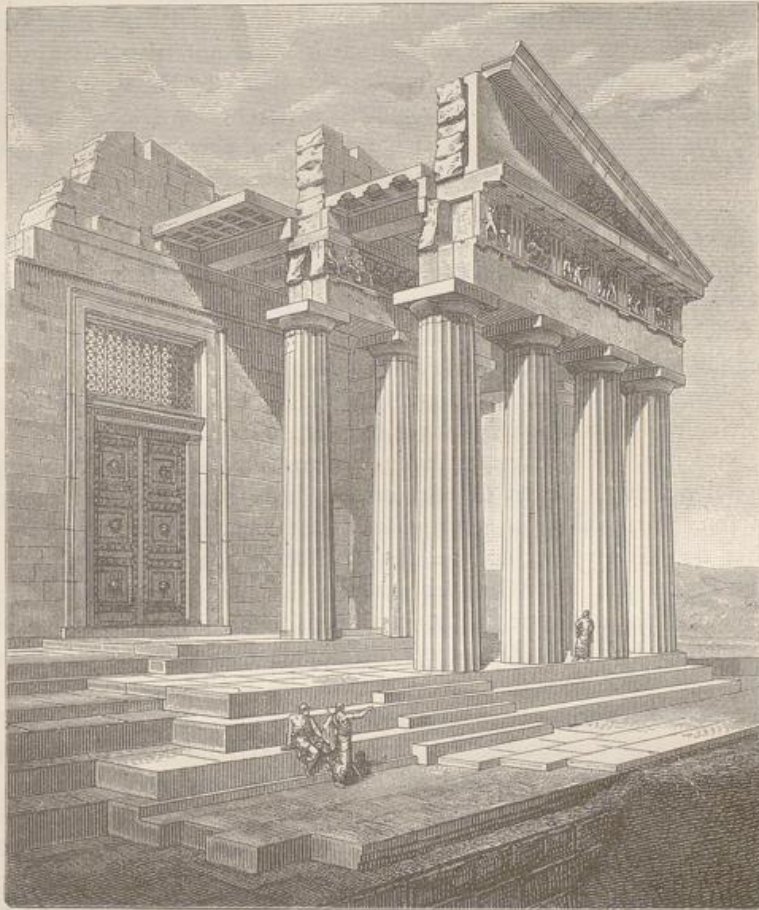
Fig. 201. Aufbau der Nordostecke des Parthenon. (Aus den Wiener archäologischen Vorlegeblättern.)
