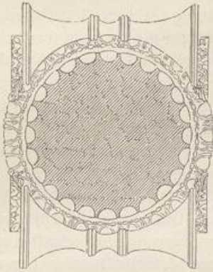
Fig. 165. Grundriss des normalen ionischen Kapitäls.
