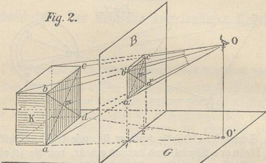
Zwischen dem Körper und dem Auge sei die als durchsichtig gedachte Zeichen- oder Bildfläche (B) aufgestellt; als solche dient in der Regel eine senkrecht stehende ebene Fläche\*). Gerade Linien, welche nun aus den verschiedenen Eckpunkten a, b, c, d.... des Körpers nach dem Auge (O) gezogen oder gedacht werden, bezeichnen den Weg der aus diesen Punkten zurückgeworfenen Licht-, bzw. Sehstrahlen.
