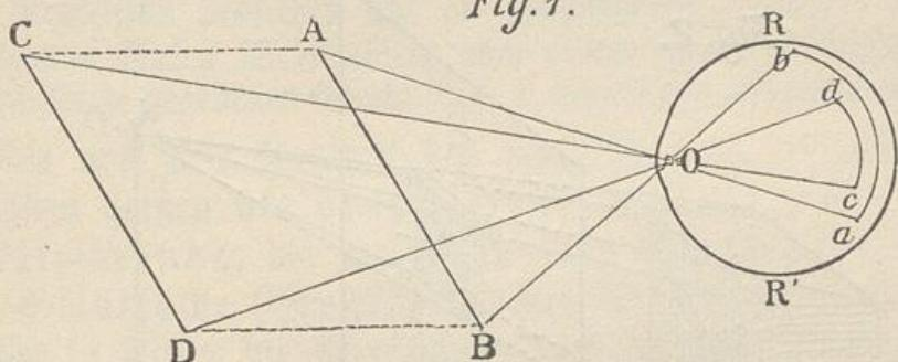
den Sehwinkel C O D\*); letzterer ist, wie leicht ersichtlich, der kleinere Winkel, und daraus erhellt, daß die scheinbare Größe eines Gegenstandes abhängig ist von dem Winkel, unter welchem er gesehen wird, und dieser Winkel um so kleiner sein wird, je größer die Entfernung des Gegenstandes vom Auge ist.
