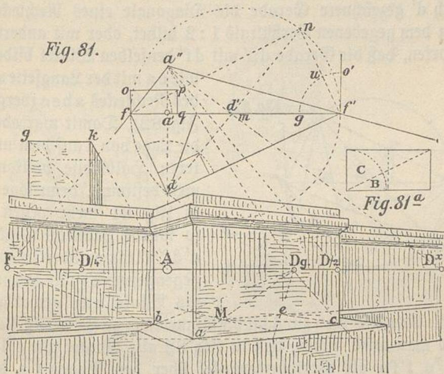
Winkel  $C$  bei  $f'$  an das verkleinerte Bild des Horizontes, also an  $ff'$  an, verlängert einen dieser Schenkel, also z. B.  $fp$  oder  $fu$ , bis der Kreis in  $n$  getroffen wird, und zeichnet von  $n$  durch  $d'$  eine Gerade, bis der entgegengesetzte Halbkreis in  $d$  geschnitten wird, ferner aus  $d$  eine zu  $ff'$  Rechtwinklige, so ist dann wieder  $a'$ , sowie durch Ziehen von  $a''a'$  gegen den Horizont der Augenpunkt und damit alles Weitere bestimmt\*).
