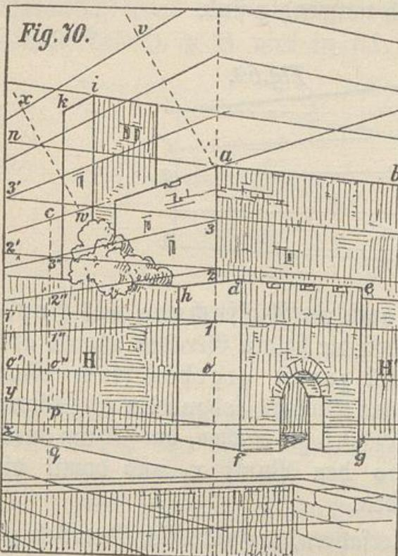
und o'y gegen abwärts in p.q..., y.z... wiederholt anträgt. Hat man auf diese Weise eine genügende Anzahl von Parallellinien für die gegebenen Richtungen gefunden, so können Gegenstände, deren Kanten, wie z. B. de, fg oder dh, ik, die gleiche Richtung haben, leicht nach dem Gefühl gezeichnet werden.
