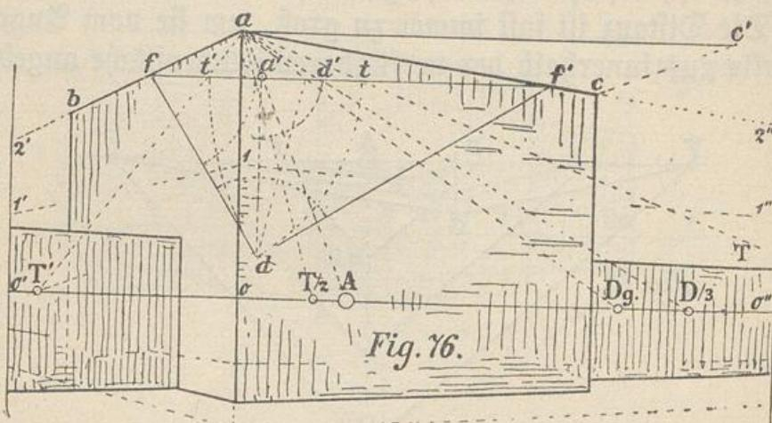
$T'$  als Teilungspunkt für alle mit  $a$   $c$  parallelen Geraden ergiebt. Punkt  $T$  oder  $T/2$  wurde in gleicher Weise und  $Dg$  dadurch gefunden, daß man den Winkel  $fdf'$  halbierte, wodurch  $ff'$  geschnitten wurde, und sodann von  $a$  durch diesen Schnittpunkt gegen den Horizont eine Gerade zog  $rc$ .
