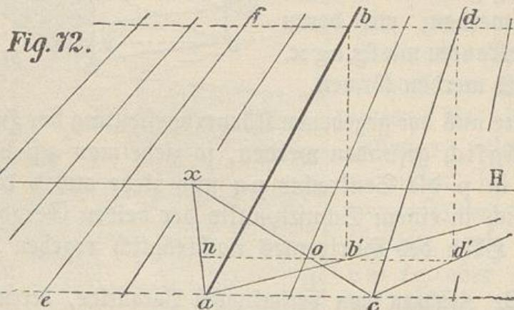
zu  $ab$  gefunden ist. Um weitere Parallelen zu erhalten, trage man etwa  $bd$  in  $bf \dots$ , ebenso  $ac$  in  $ae \dots$  wiederholt an  $xc$ ; daß  $ab$ ,  $cd$  Parallelen sind, geht daraus hervor, daß  $c'd'$  parallel und gleich  $ab'$ , ebenso  $d'd$  parallel und gleich  $b'b$ , folglich auch  $ab$ ,  $cd$  Parallelen (und die Strecken  $ab$ ,  $cd$  gleich) sind.
