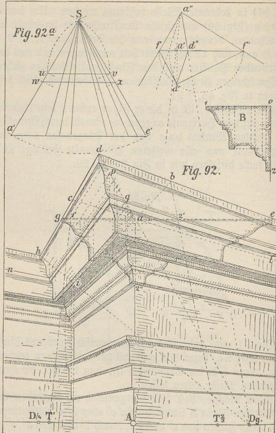
§ 139. Aufgabe: Konstruktion eines Kranzgesimses nach einer anderen Methode.
