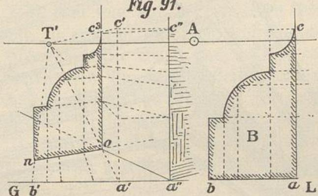
Fig. 91 zeigt, wie ein bei B geometrisch gegebenes Simsprofil über  $n\ o$ , bezw. von  $o\ c^3$  aus perspektivisch zu zeichnen war, wenn GL die Grundlinie ist, von welcher die anzutragenden Maße gelten sollen.
