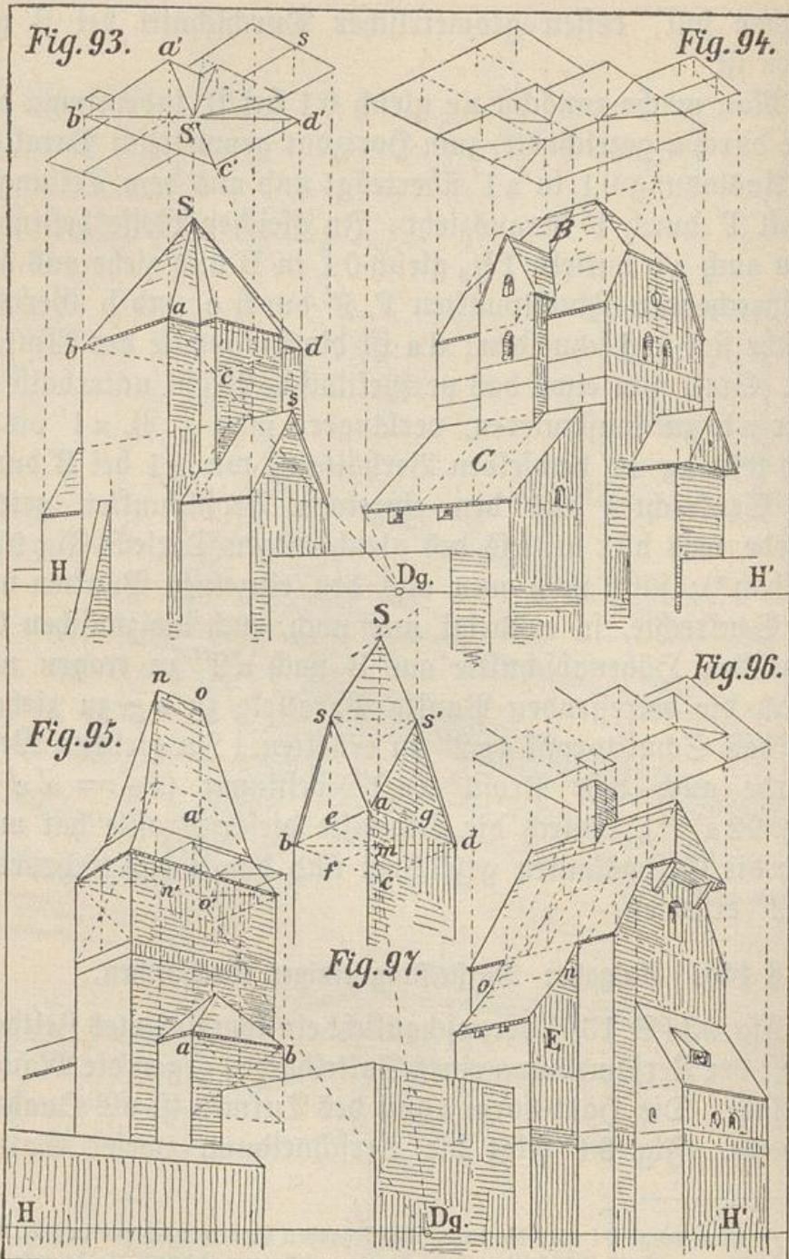
oder Walmdächer, von denen das größere B als ein sogen. Krüppelwalm bezeichnet wird; die übrigen Verschneidungen, wie z. B. des Pultdaches C usw., sind leicht zu ersehen.
