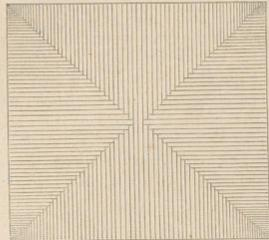
Der normale Durchschnitt der Gewölbe zeigt daher nicht (wie bei Lübke's Abbildung) Kreislinien, sondern gerade Linien, wie in den verschiedenen Durchschnitten Bl. 11 und 12 angegeben. Die Diagonallinien bilden deshalb, obwohl ziemlich über den Scheiteln der Gurten erhöht, keine Halbkreise, sondern parabelartige Linien.
