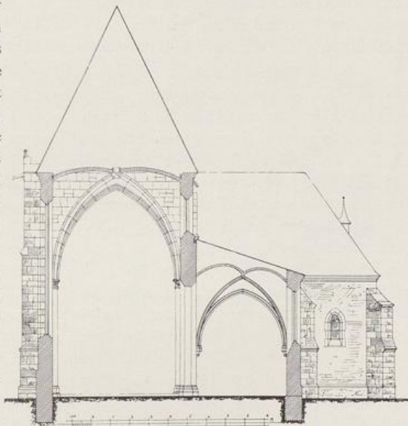
Fig. 104. Kreuzau. Querschnitt durch die kathol. Pfarrkirche vor der Erweiterung.
