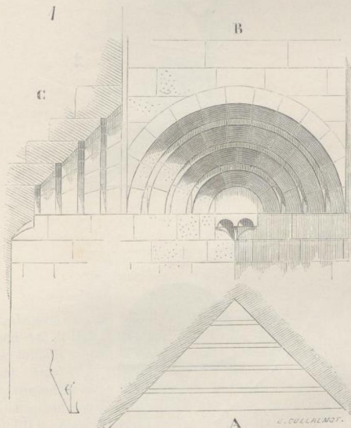
posée d'arcs concentriques biseautés à 45 degrés, de manière à pénétrer les côtés du carré. En A est tracée la projection horizontale d'une de ces trompes, en B son élévation, en C sa coupe. Ces sortes de trompes sont les plus anciennes, on en trouve dans les monuments du xi<sup>e</sup> siècle;
