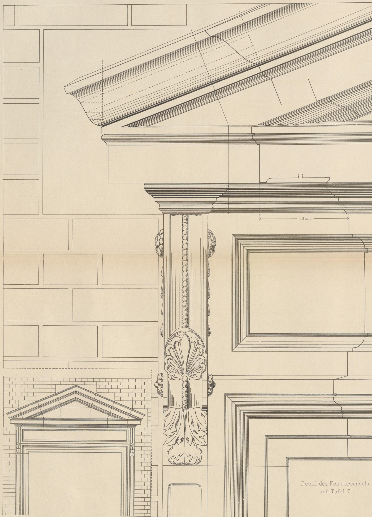
Detail einer Fensterverdachung aus Sandstein
