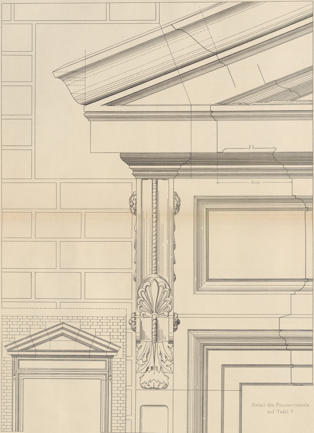
Detail einer Fensterverdachung aus Sandstein
