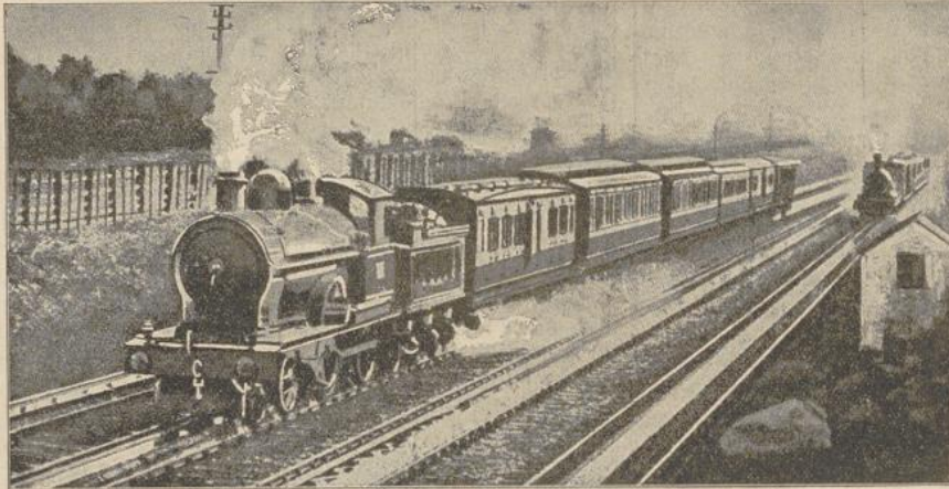
Abb. 1. Wassertrog auf einer englischen Bahn im Augenblicke der Wasseraufnahme durch eine Zuglokomotive.
