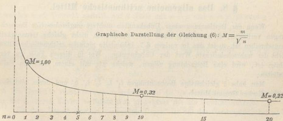
Die Kurve läuft asymptotisch aus, d. h. der mittlere Fehler  $M$  nähert sich unbegrenzt der Null, ohne den Wert Null selbst je zu erreichen. Die ersten 5—10 Wiederholungen geben rasch eine Abnahme von  $M$ , d. h. eine Genauigkeitssteigerung; dann aber hat weiteres Wiederholen wenig Erfolg, und um den mittleren Fehler einer ersten Messung auf ein Zehntel seines Wertes herunter zu bringen, müsste man 100 Wiederholungen machen.
