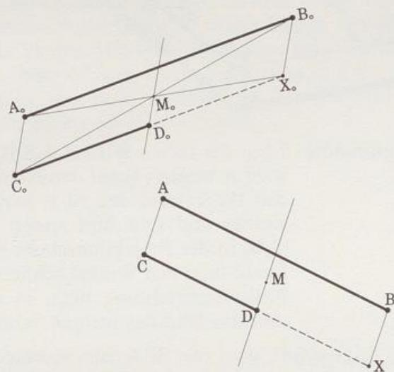
(6) **Ist eine Strecke  $[A_0B_0]$  n-mal so lang wie eine dazu parallele Strecke  $[C_0D_0]$ , so ist auch die Bildstrecke  $[AB]$  n-mal so lang wie die (dazu parallele) Bildstrecke  $[CD]$ .**
