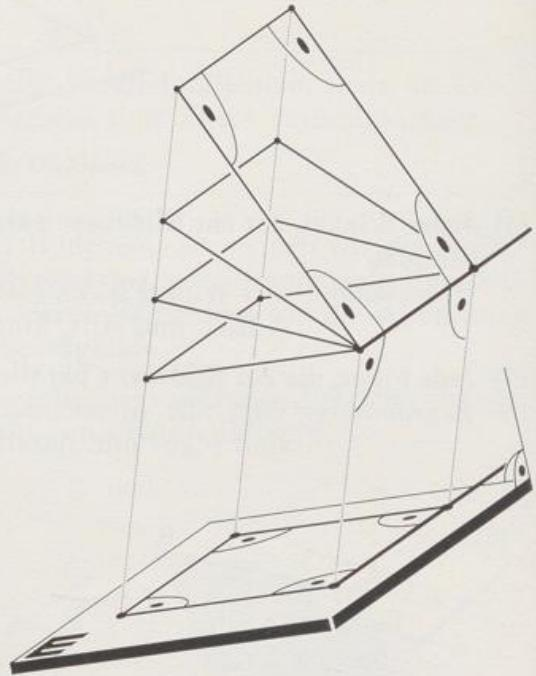
*Begründung:* Liegt der rechte Winkel  $A_0S_0B_0$  schon parallel zur Bildebene E, dann wird er wegen (4) auf den rechten Winkel ASB abgebildet. Dreht man den Winkel um den zu E parallelen Schenkel  $[S_0A_0]$ , so bleibt er ein rechter und sein Bild ändert sich nicht, weil der andere Schenkel  $[S_0B_0]$  in der Projektionsebene  $S_0SB$  liegt.
