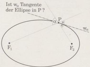
Das Bild zeigt einen Ellipsenpunkt P und eine Winkelhalbierende  $w_\alpha$  der Brennstrahlen  $[F_1P]$  und  $[F_2P]$ . Dem Augenschein nach ist  $w_\alpha$  Tangente der Ellipse in P. Aber nicht nur dem Augenschein nach! Mit einem kleinen Trick lässt sich das beweisen: Man spiegelt einen der beiden Brennpunkte an  $w_\alpha$  (Spiegelpunkt  $F_2^*$ ). Wegen Achsensymmetrie ist  $\overline{PF_2} = \overline{PF_2^*}$ .
