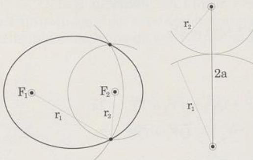
Herleitung der Ellipsen-Gleichung aus der Beziehung  $\overline{PF_1} + \overline{PF_2} = 2a$
