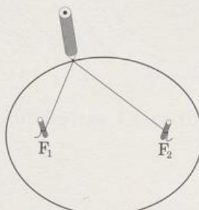
Die Ellipseneigenschaft, die der Gärtner-Konstruktion zugrunde liegt, führt auch zu einer Konstruktion einzelner Ellipsenpunkte: Man zeichnet um die Brennpunkte Kreise, deren Radien zusammen  $2a$  ergeben; die Schnittpunkte sind Ellipsenpunkte.
