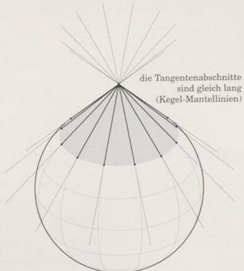
$P$  sei ein beliebiger Punkt der Schnittellipse. Weil die Schnittebene auch Tangentialebene der beiden Dandelin-Kugeln ist, sind  $PF_1$  und  $PF_2$  Tangenten dieser Kugeln. Die Mantellinie durch  $P$  schneidet die beiden Berührkreise  $k_1$  und  $k_2$  in  $Q_1$  und  $Q_2$ .  $PQ_1$  und  $PQ_2$  sind also auch Tangenten der Dandelin-Kugeln. Alle Kugel-Tangantenabschnitte durch einen Punkt sind gleich lang. Deshalb gilt:
