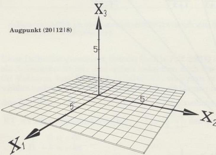
Bilder, die der Wirklichkeit noch näher kommen, liefert die **Zentralprojektion**. Fotografien sind Bilder in Zentralprojektion. Zeichnungen in Zentralprojektion setzen eine anspruchsvollere Konstruktionstechnik voraus. Bei der Zentralprojektion werden nicht nur Strecken und Winkel verzerrt, auch das Teilverhältnis ändert sich im allgemeinen.
