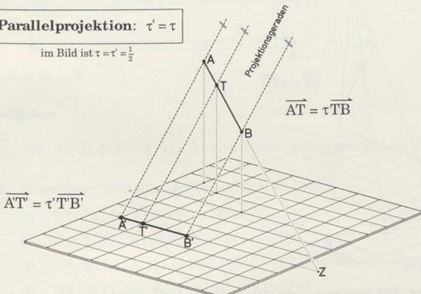
Fast alle Zeichnungen in diesem Buch, die räumliche Ansichten zeigen, sind Normalbilder in Parallelprojektion. Eine Abbildung eines Körpers in eine Ebene heißt **Parallelprojektion**, wenn die Geraden, die Urbild- und Bildpunkt verbinden, parallel sind. Die Ver-
